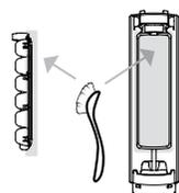
Nettoyez les joints et les plateaux démontés à l'aide d'une brosse douce et de l'eau savonneuse (max 65°C).
